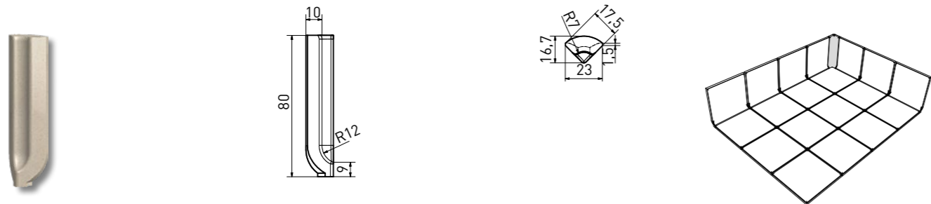
vnitřní roh sokl s pozlábkem | TSIRH... | 80×23×10 mm
